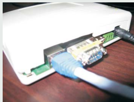
接頭由左至右為 RJ-45、RS232 (DB9)、USB、電源
